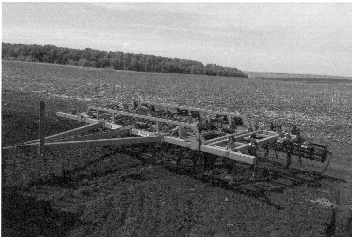
Рисунок 1. Культиватор для сплошной обработки почвы КПМ-6. Общий вид машины.
